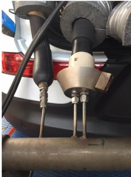
Entnahmevorrichtung der Abgase
