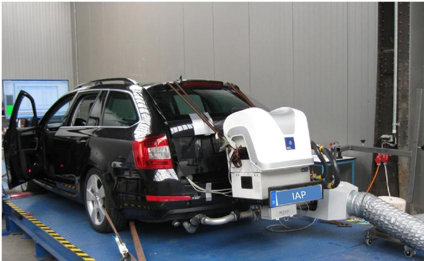
Messfertige Aufspannung des Fahrzeuges auf dem Rollenprüfstand
